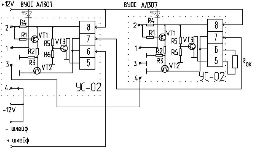
Схема подключения датчиков ИП 212-41М к двухвыводным концентраторам и схема подключения ВУОС
