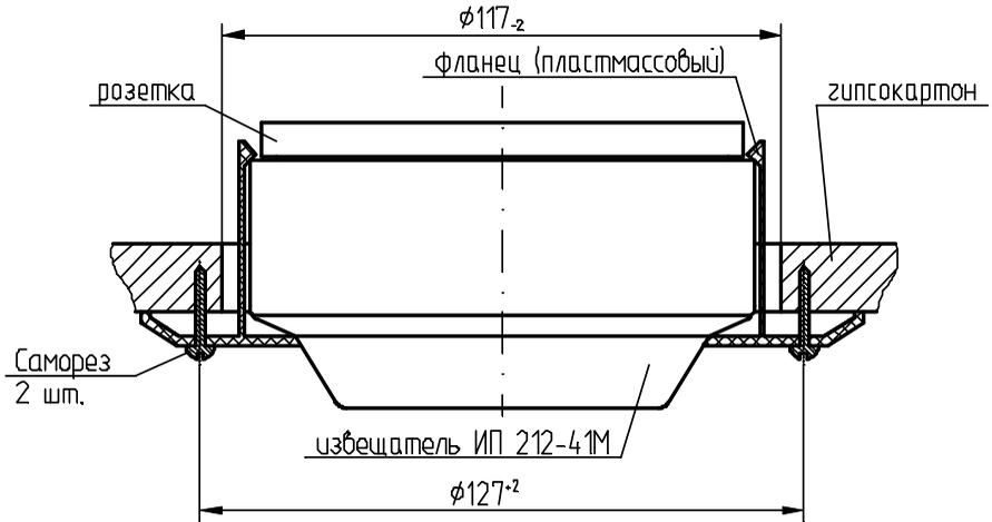
Допускается крепление розетки извещателя к подвесному потолку без использования комплекта монтажных частей
