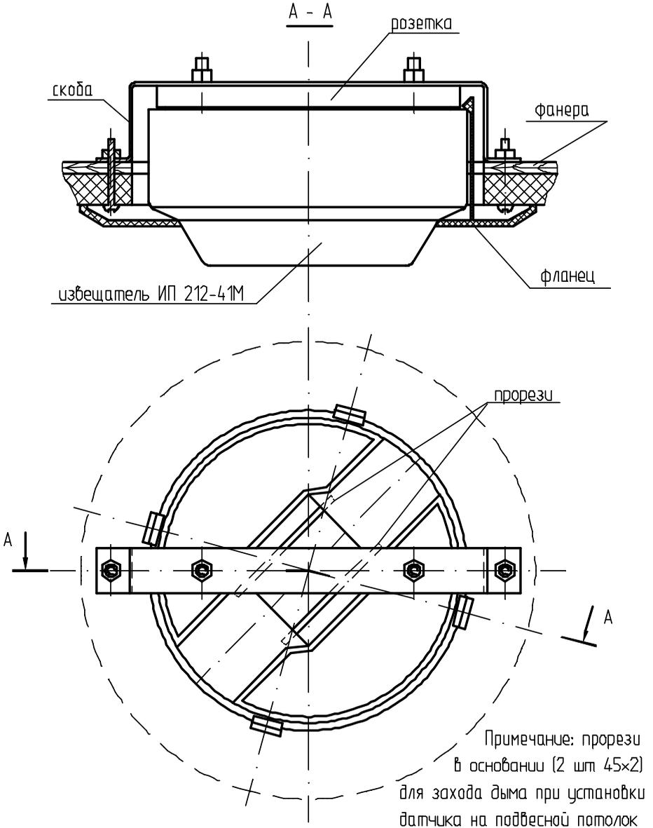
Крепление извещателя к подвесному гипсокартонному потолку с помощью саморезов и пластмассового фланца, входящего в КМЧ-1.
