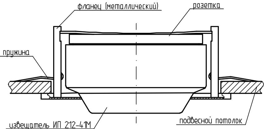
Крепление извещателя к подвесному потолку с помощью металлической скобы и пластмассового фланца (КМЧ-1).
