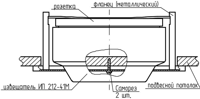
Крепление извещателя к подвесному потолку с помощью пружин и металлического фланца (КМЧ-3).
